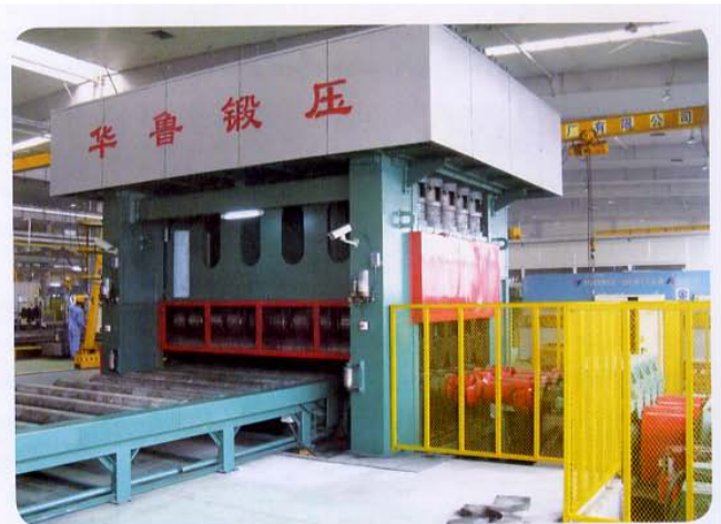
WD43M-60×3000 ( \delta \leq 345\text{MPa} ) 矫平机用于浙江盈都网架钢构有限公司 Plate straightening machine for Zhejiang Yingdu Group Co., Ltd.
