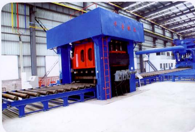
WD43M-60×3000 ( \delta \leq 345\text{MPa} ) 矫平机用于浙江盈都网架钢构有限公司 Plate straightening machine for Zhejiang Yingdu Group Co., Ltd.
