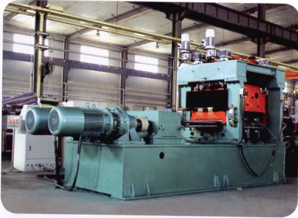
WB43M-3×800( \delta \leq 600\text{MPa} ) 钨钼板矫平机用于株洲硬质合金集团有限公司 Tungsten-molybdenum plate straightening machine used for Zhuzhou Cemented Carbide Group Corp. Ltd.
